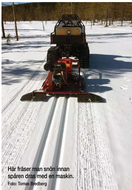
Det här redskapet från MCM gör samma jobb som rullen med den fördelen att man kan reglera trycket på spårkälken. Foto: Tomas Bredberg
