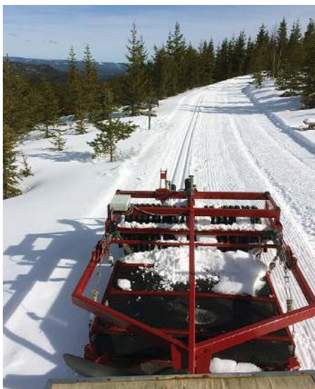
Det här redskapet från MCM gör samma jobb som rullen med den fördelen att man kan reglera trycket på spårkälken. Foto: Tomas Bredberg
