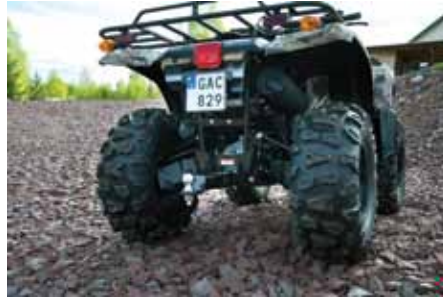
Dragkroken är ordentligt lång för att underlätta att få dit en vagn.
