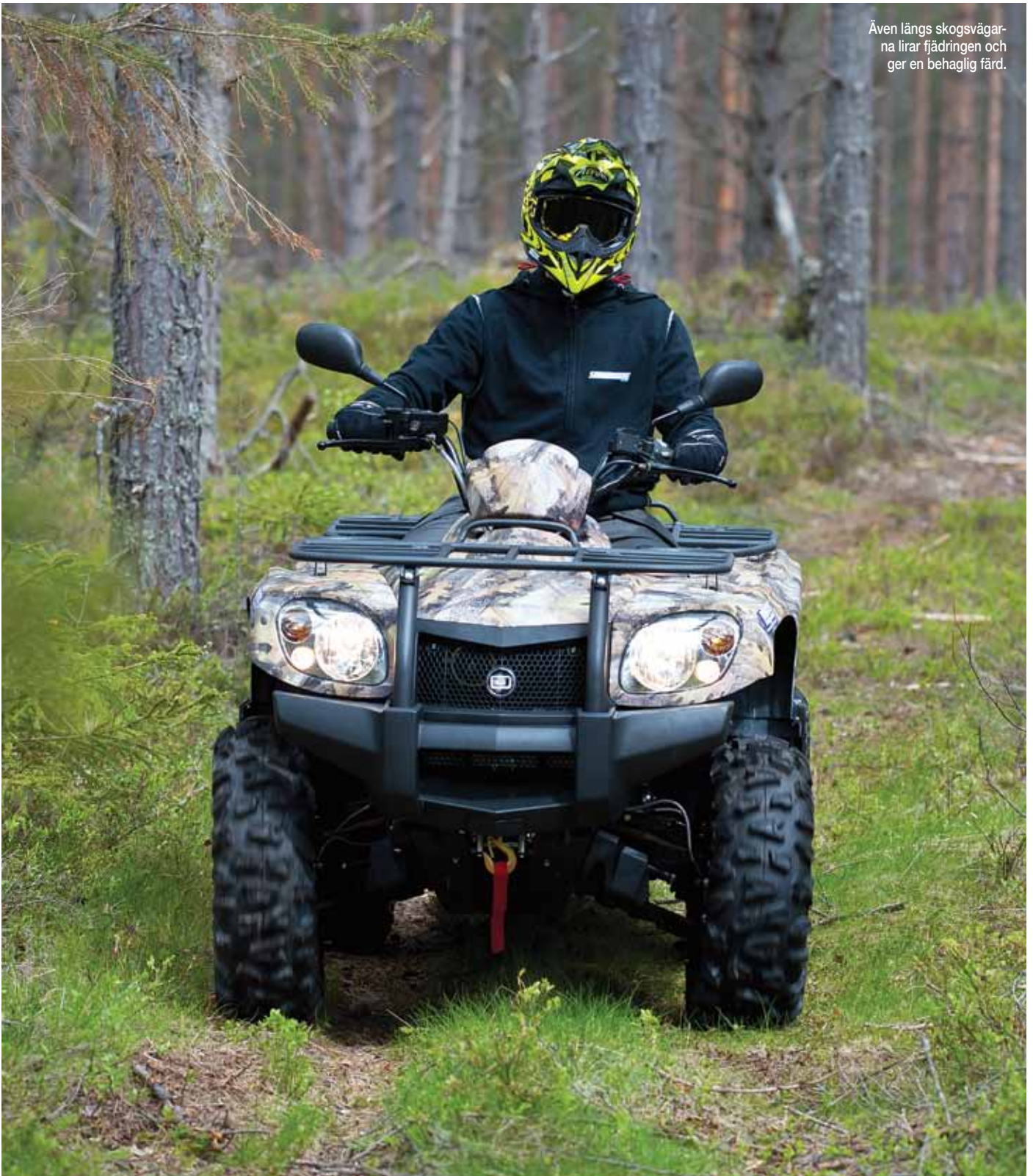
Dragkroken är ordentligt lång för att underlätta att få dit en vagn.
