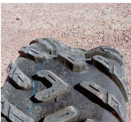
Syret i däckets äts upp av elden och däckets krymper efter några sekunder.
