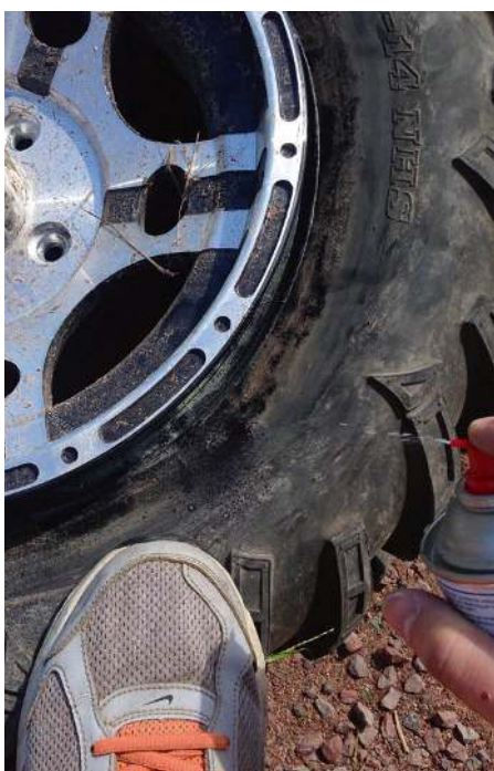
Vi tryckte ner däckets på tre ställen för att kunna spraya in i däckets.
