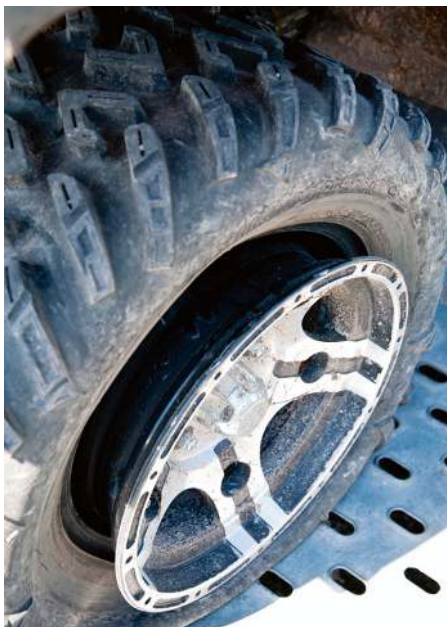
Har man kört allt för nära en stubbe eller sten kan man kränga av däckets från fälgen.
