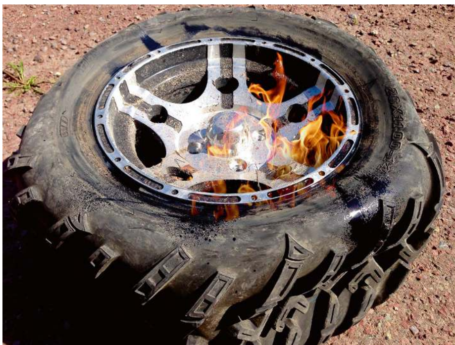
Efter en kastad tändsticka så det poff så hoppade däckets på plats, undvik att spraya utanför då det garanterat börjar brinna.
