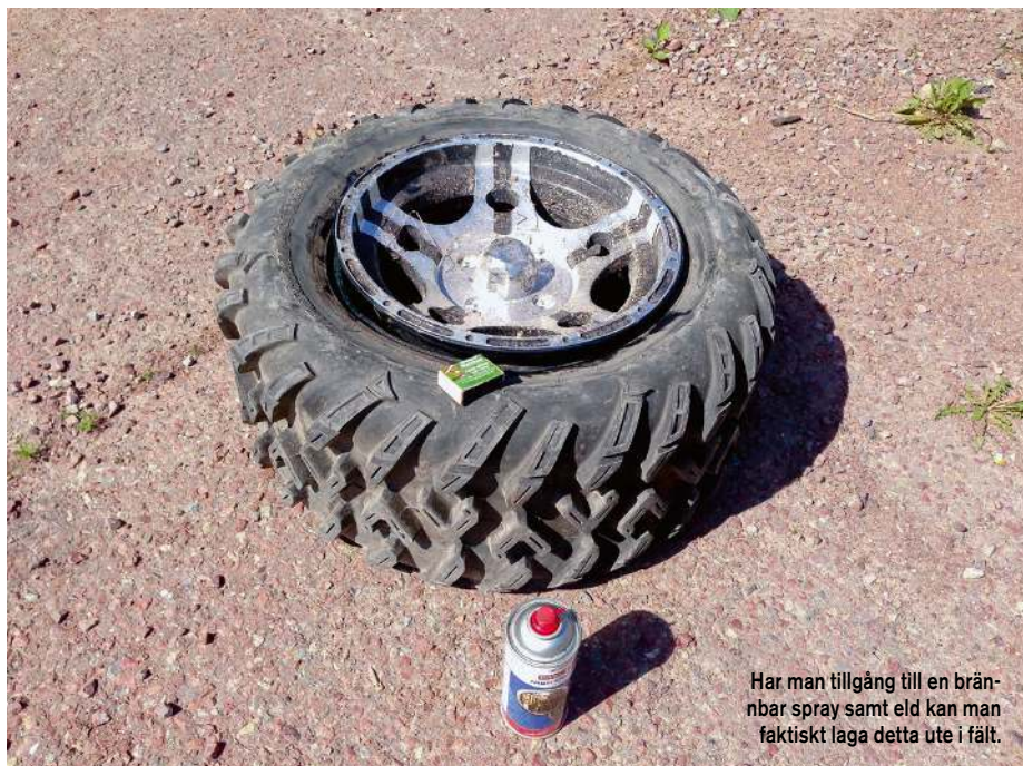
Har man kört allt för nära en stubbe eller sten kan man kränga av däckets från fälgen.
