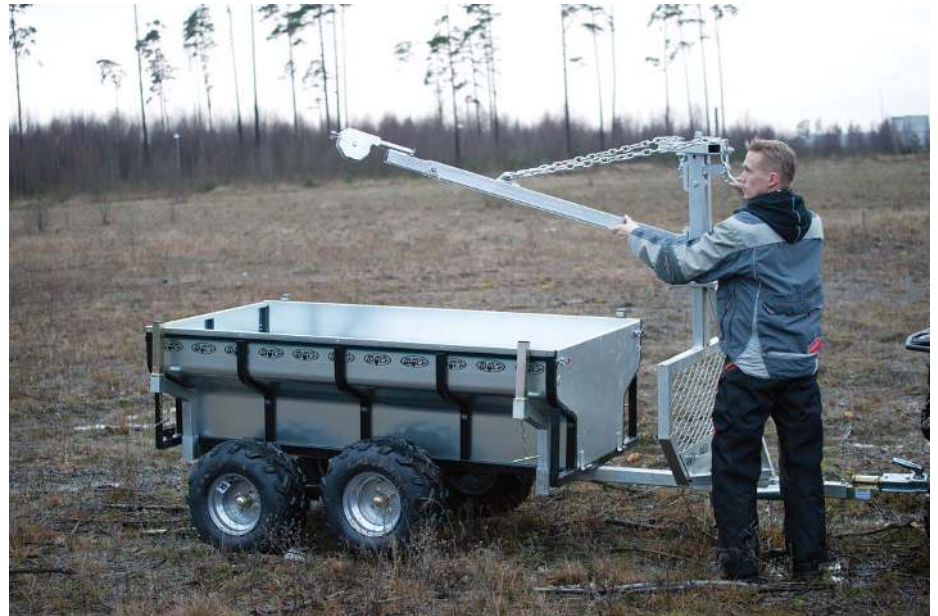
Kranen ställs i sidled med hjälp av kedjorna. Det stora löstagbara flaket rymmer över en kubikmeter och vagnen orkar med ett ton!
