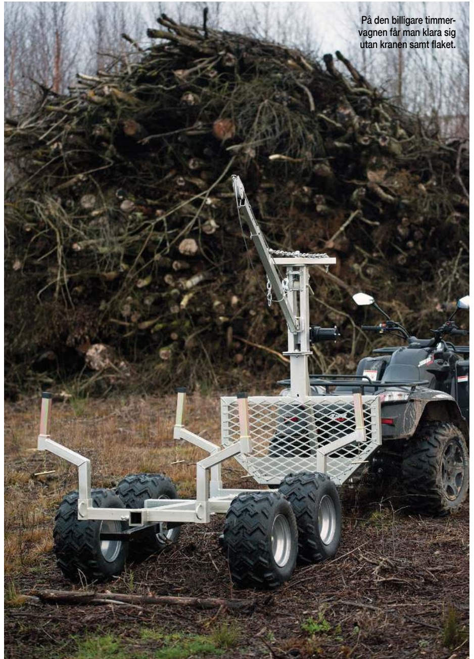
Boggin med dubbla hjulpar följer underlaget bra och har en helt okej markfrigång.
