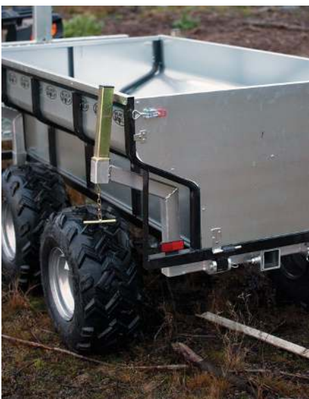
Boggin med dubbla hjulpar följer underlaget bra och har en helt okej markfrigång.
