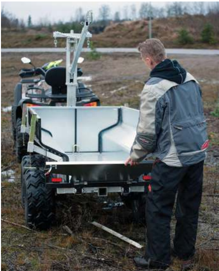
Lämnen bak går enkelt att fälla när man ska lasta på eller av.
