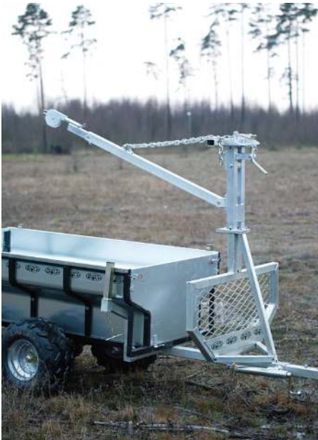
På kombivagn med flak ingår det en kran för smidig lastning av timmer, man behöver dock även en vinsch.
