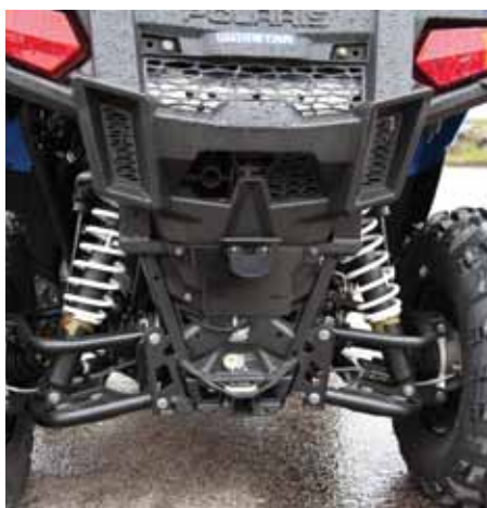
Bak har ACE ställbar förspänning på de rejäla stötdämparna.
