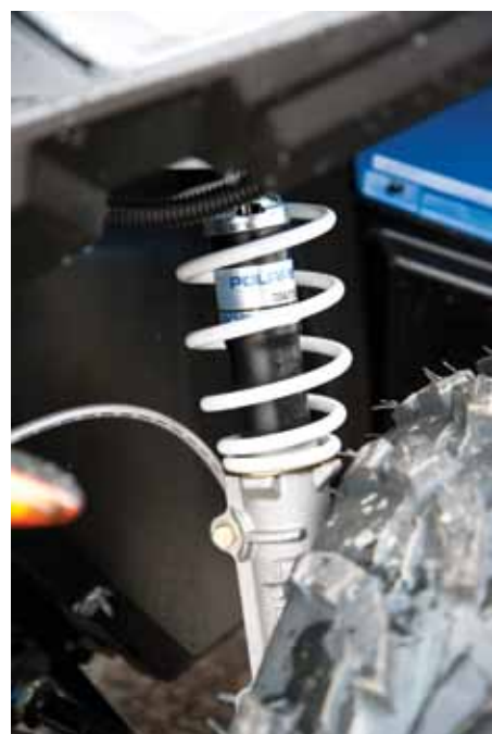
På MacPherson-benen fram finns det ingen möjlighet att justera dämparna.
