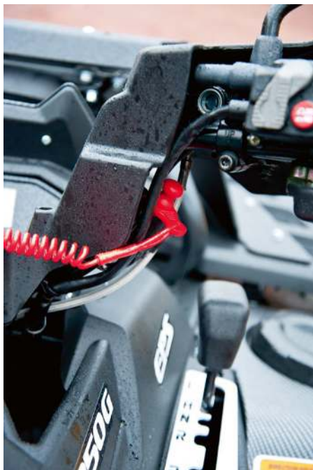
Ett dödmansgrepp är inte alls dumt att ha på denna typen av maskin.
