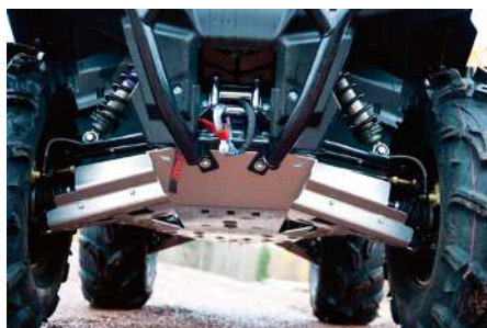
Maskinen är väl skyddad undertill, både buk och A-armor. Även vinsch är standard.
