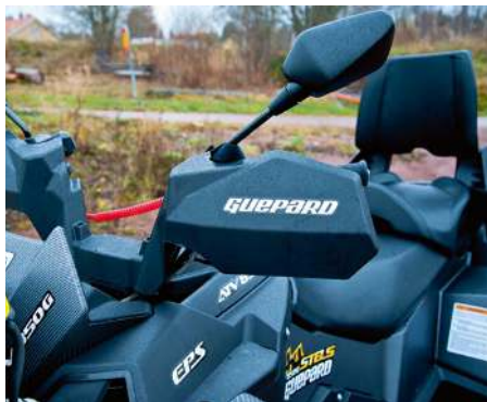
Händerna är väl skyddade av de integrerade handtagsskydd.
