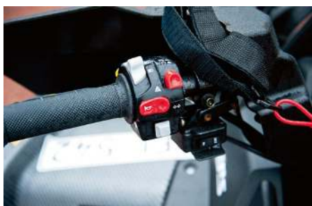
Här sköter man det mesta på ett enkelt sätt, även vinschkontrollen sitter här.
