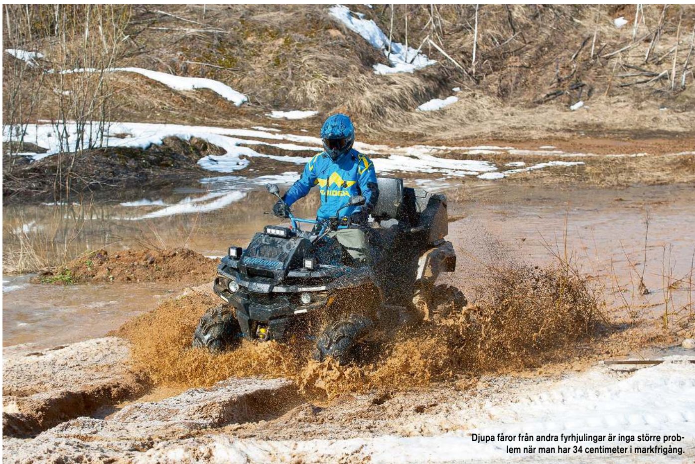
Maskinen är väl skyddad undertill, både buk och A-armor. Även vinsch är standard.
