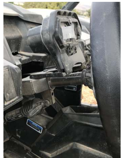
Ratten är ställbar i höjdlid 25° för att alla ska kunna hitta bästa körställning.
