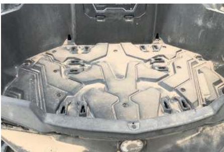
Här lastar man 136 kilo, flaket är utrustat med åtta stycken LinQ quick-fästen, fyra fästögglor och dräneringshål.
