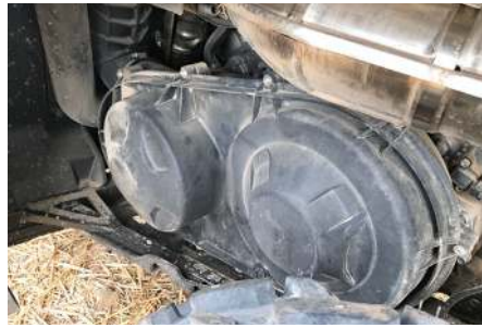
Titta vad öppet variatorerna sitter på Trail, inga problem att komma åt vid ett eventuellt rembyte.
