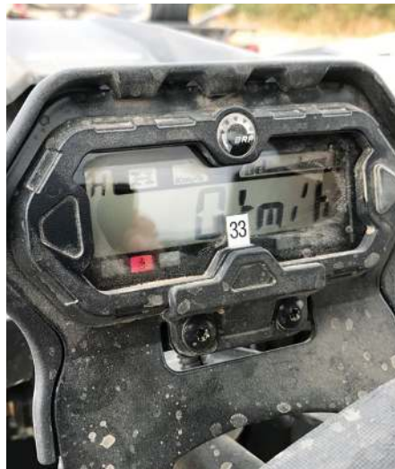
Liten digital mätare där det mest matnyttiga visas, desdusom följer den med ratten när den justeras.
