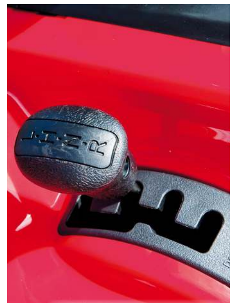
Växelväljaren löper i en kulisss med fasta lägen och det finns inget P-läge att tillgå.
