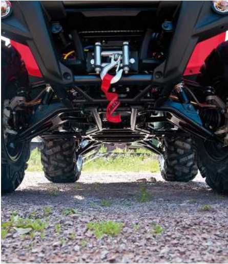
Hela 31 cm i markfrigång plus de böjda nedre A-armarna fram ger goda terrägegenskaper.
