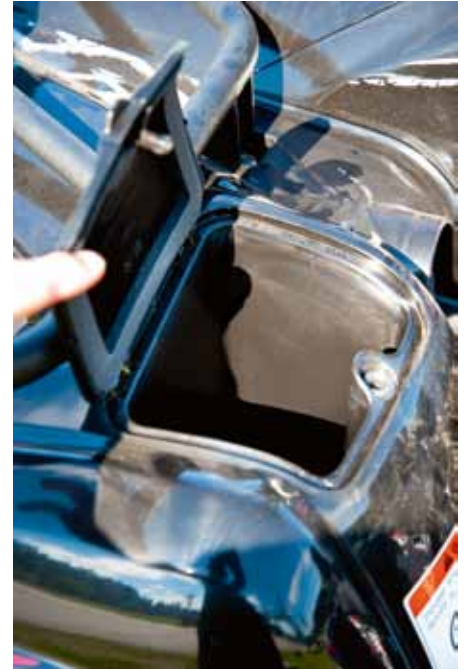
Det finns gott om förvaringsmöjligheter, dessa är placerade i vardera skärm.
