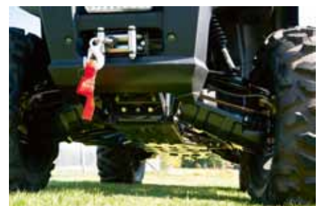
Skyddande plast både på underredet och A-armarna fram och bak. Den nödvändiga vinschen är standard.
