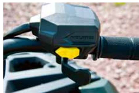
Med denna knapp reglerar man hjuldriften och ADC, valt läge syns på displayen.
