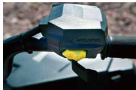
Via den här gula knappen väljer man mellan två- och fyrhjulsdrift samt ADC.
