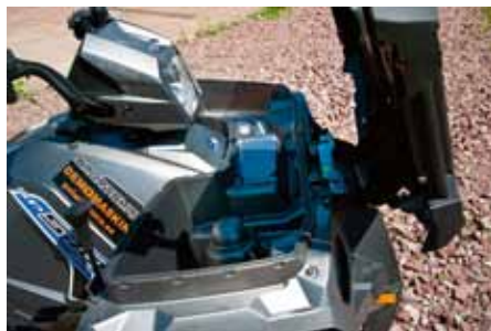
Förvaringsboxen fram har en volym på 24 liter och även om man har packning ovanpå kan man öppna locket. Tillsammans med bakre lastracket kan man totalt lasta 220 kilo på 570 SP.
