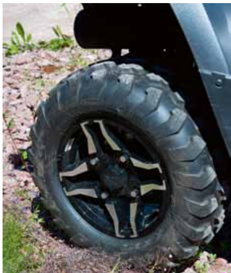
14" fälgar i aluminium, 8" breda fram och 10" bak med Maxxis-däck på 26".
