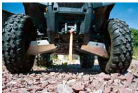
Fram får man A-armsskydd i aluminium och markfrigång- gen mäter närmare 30 centimeter.
