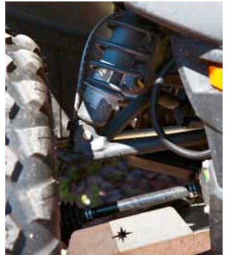
570 SP har dubbla A-armar både fram och bak med förutbestämda fasta lägen för förspänningen.
