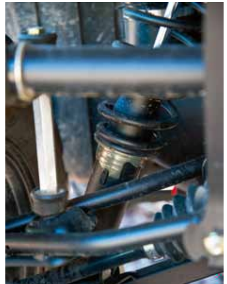
570 SP har dubbla A-armar både fram och bak med förutbestämda fasta lägen för förspänningen.
