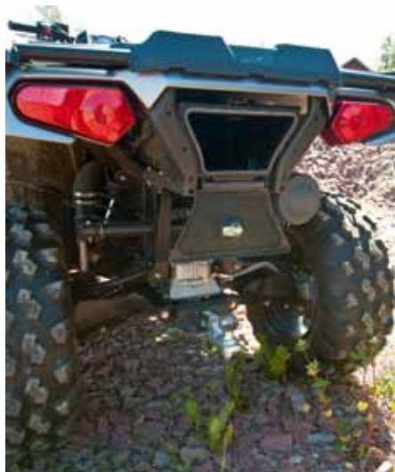
I mitten bak sitter det tätade lite mindre förvaringsfacket.
