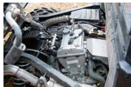
När flaket fälls blottas hela motorn och det är enkelt att komma åt vid service.
