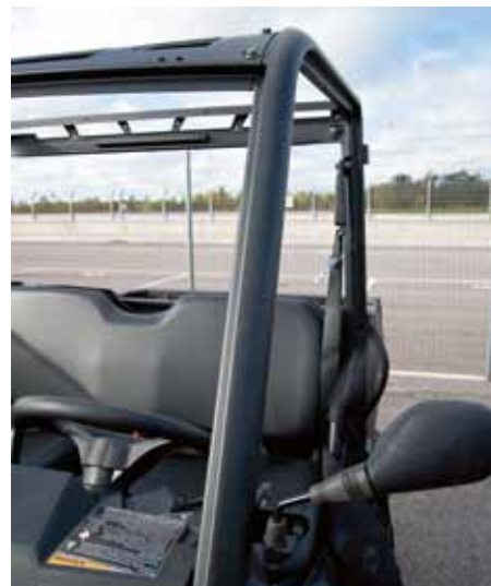
Den skyddande buren har ett nytt utseende vilket gör det enklare att montera en hytt.
