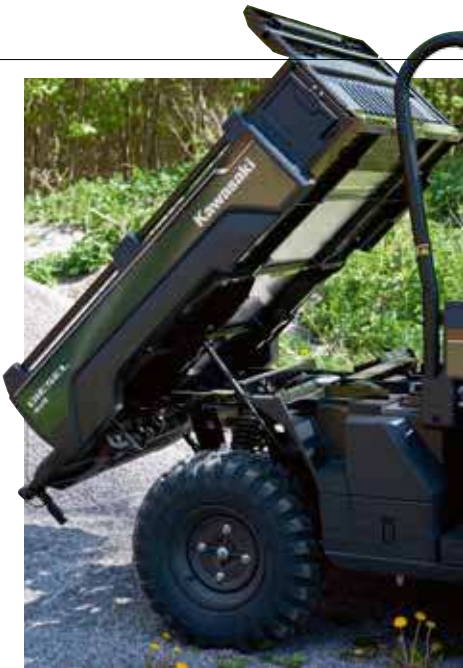
Flaket är enormt och kan ta 453 kilo med dimensionerna 1375 mm längd x 1355 mm bredd x 280 mm höjd.
