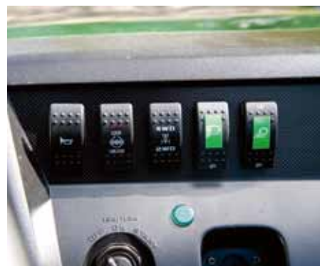
Mule har nu elektronisk diffspärr och LED-strålkastare som kan användas som arbetsbelysning.
