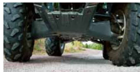
Här under sitter det plastskydd överallt där man behöver skydd.
