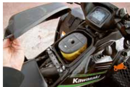
Dynan tar man enkelt bort med hjälp av en spak på sidan och sedan kommer man enkelt åt saker som säkringar, batteri och luftfilter.
