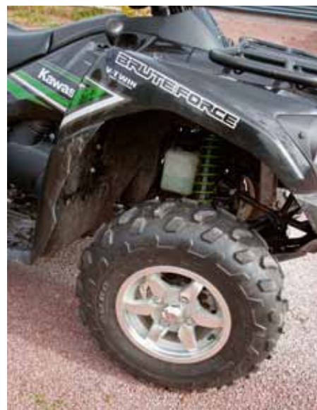
På Brute Force sitter det Duro DI-K911-däck, ett mångsidigt terrängdäck, på 12 tums aluminiumfälgar.
