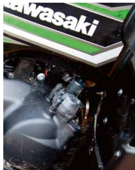
Ovanpå variatorkåpan så sitter den el-motor som ser till att man har en motorbroms.
