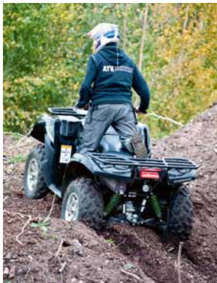
Man börjar klättringen med fyrhjulsdriften vald och om det börjar spinna så greppar man bara den gula spaken för att återfå fästet.
