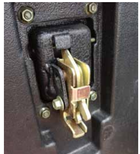
Här hittade vi anledningen till att dörren börjat krångla lite, en skruv hade lossnat.
