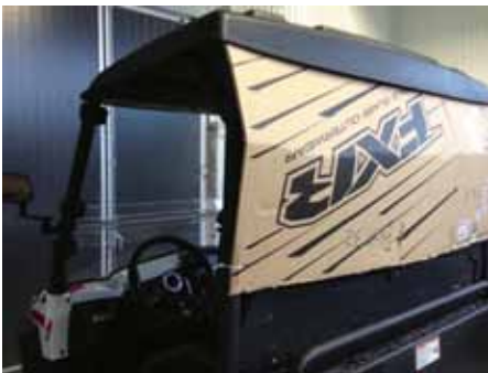
Innan vi gör en bakruta i plexiglas eller liknande testade vi om vinddraget minskade genom att montera en kartongbit. Visst blev det bättre då det inte drar direkt i nacken, men väl från sidorna.
