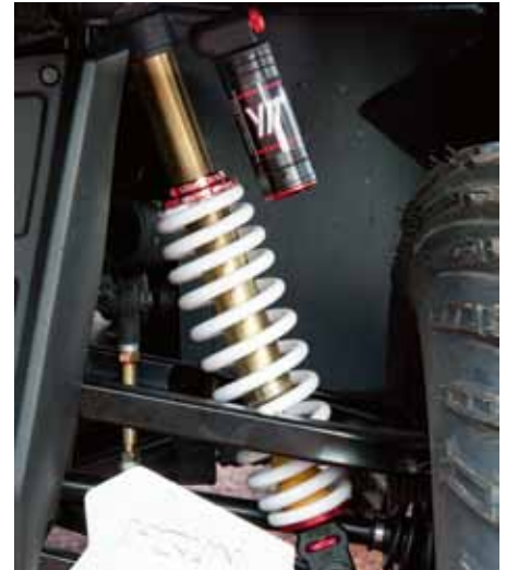
På dessa dämpare kan man ställa allt från förspänning till kompression och retur. Vi började med allt ställt i mitten av sitt justeringsområde.
