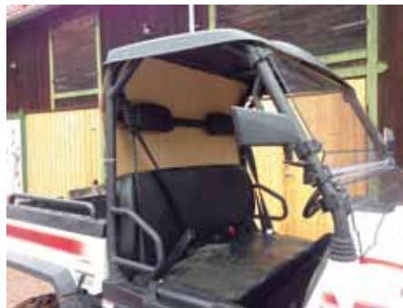
Innan vi gör en bakruta i plexiglas eller liknande testade vi om vinddraget minskade genom att montera en kartongbit. Visst blev det bättre då det inte drar direkt i nacken, men väl från sidorna.
