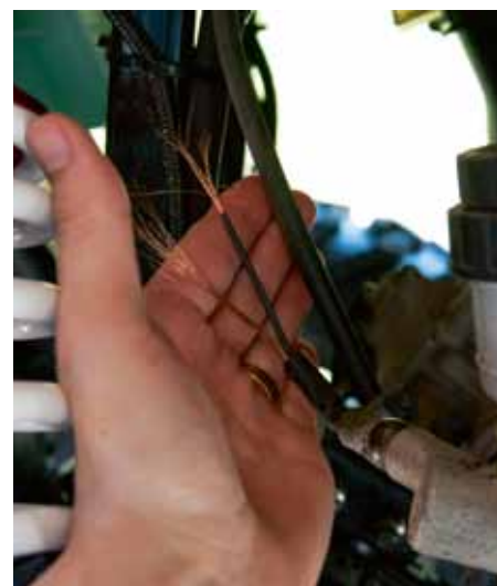
Efter att vi stängt av maskinen så gick den helt plötsligt inte att starta! Felet var denna sladd som går till bromsen, snabbblösningen blev att tvinna ihop de två ändarna.
