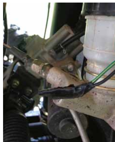
Efter att vi stängt av maskinen så gick den helt plötsligt inte att starta! Felet var denna sladd som går till bromsen, snabbblösningen blev att tvinna ihop de två ändarna.
