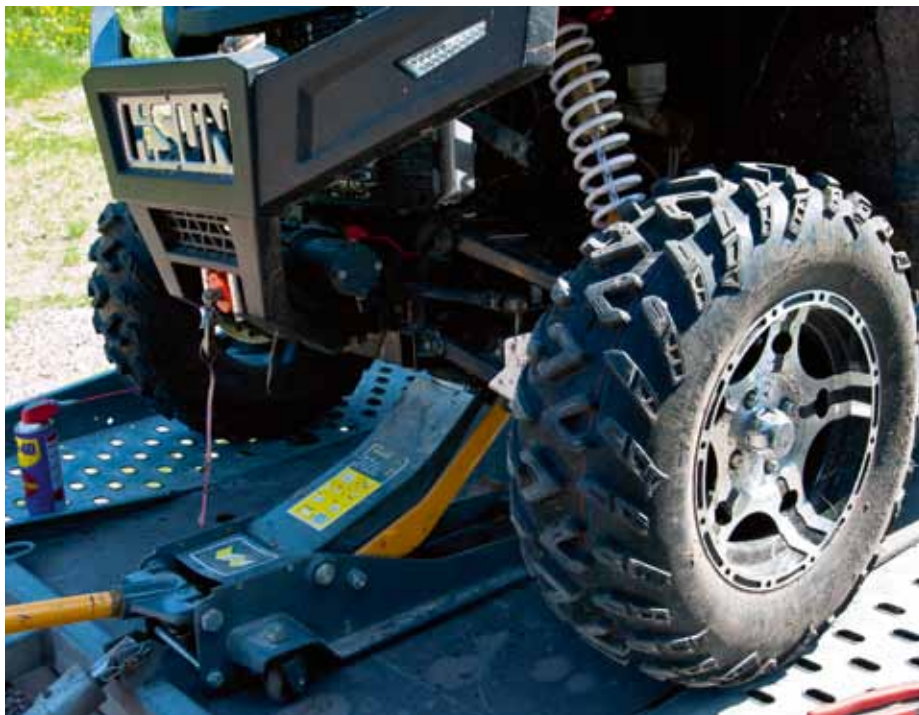
För att justera förspänningen är det nästan en förutsättning att man tar bort vikten från hjulen, annars orkar man inte skruva på fjädern.
