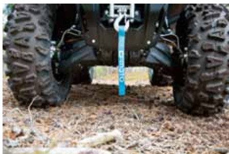
C Force 520 är bra skyddad under med plast på alla A-armar och på underredet, och fram sitter även en vinsch.
