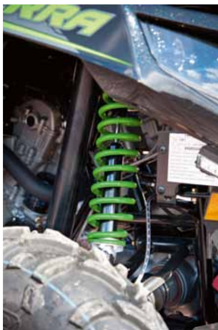
Med förspänningen på lägsta läget får man en mycket harmonisk maskin som jobbar bra i fjädringen, både på väg och i terräng.
