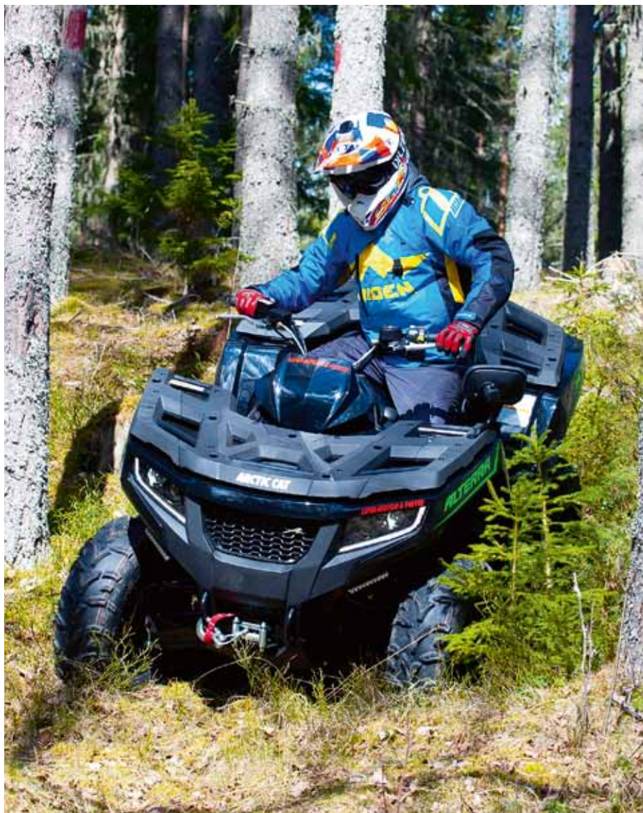
Med inbyggd EBS bromsas framfarten mycket bra utför, lite mer med lågväxeln i och lite mindre med högväxeln.
