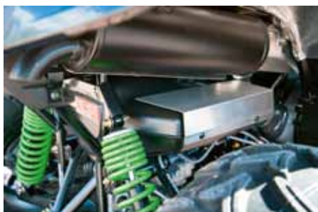
Här ser vi den låga placeringen av bränsletanken.
