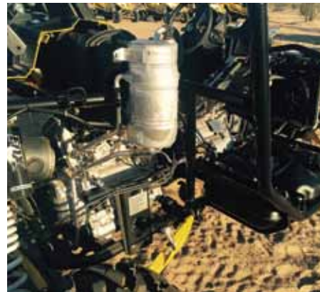
För att motorn alltid ska vara försäkrad om att få olja så är smörjsystemet av så kallad torrsump-typ vilket är bättre i alla lägen.
