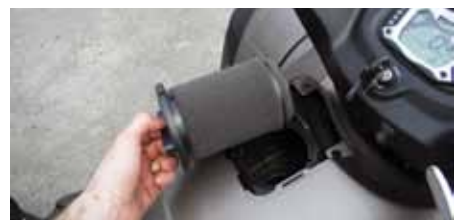
Lättåtkomligt luftfilter med hög placering gör servicen enkel.
