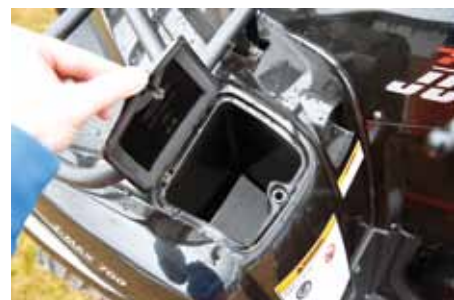
Förutom ett fack längst bak på fyrhjulingen har man två placerade fram, ett i vardera skärm.
