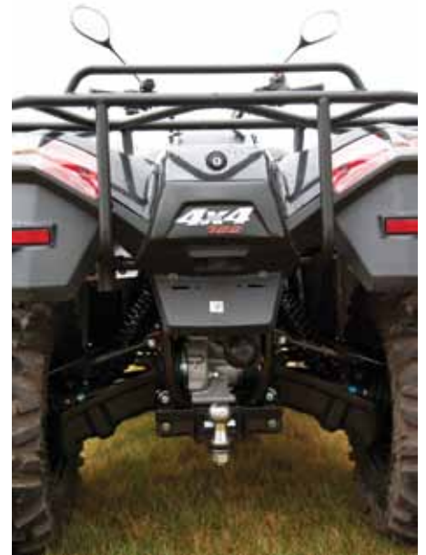
Bak hittar vi dragkrok med tillhörande kraftuttag.
