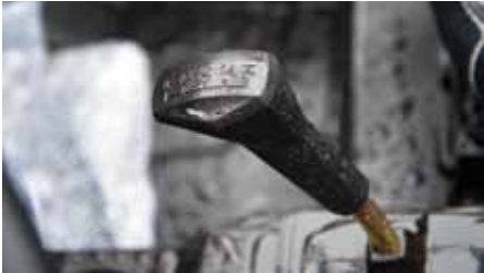
Alla lägen man behöver finns och man kör med fördel på lågväxeln när man kryper runt i terrängen, detta för att spara remmen.
