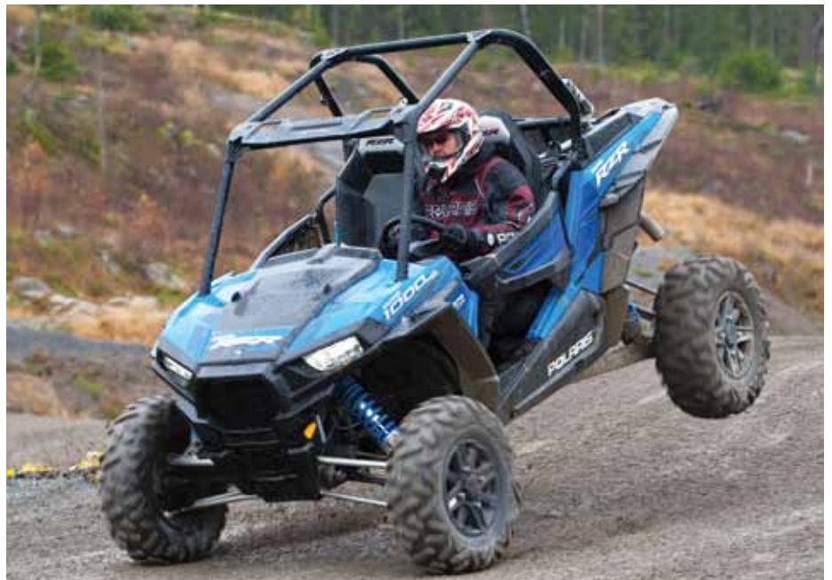
Dämparna som kommer från Walker Evans är av nåltyp och har clicker med 16 läges justering av kompressionen.
