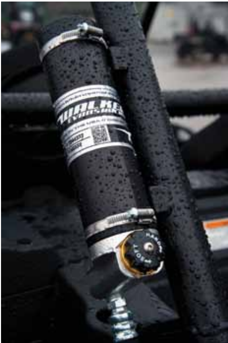
Dämparna som kommer från Walker Evans är av nåltyp och har clicker med 16 läges justering av kompressionen.
