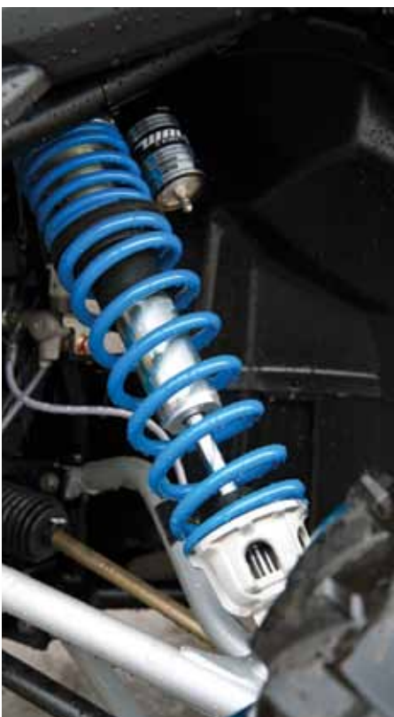
Dämparna som kommer från Walker Evans är av nåltyp och har clicker med 16 läges justering av kompressionen.
