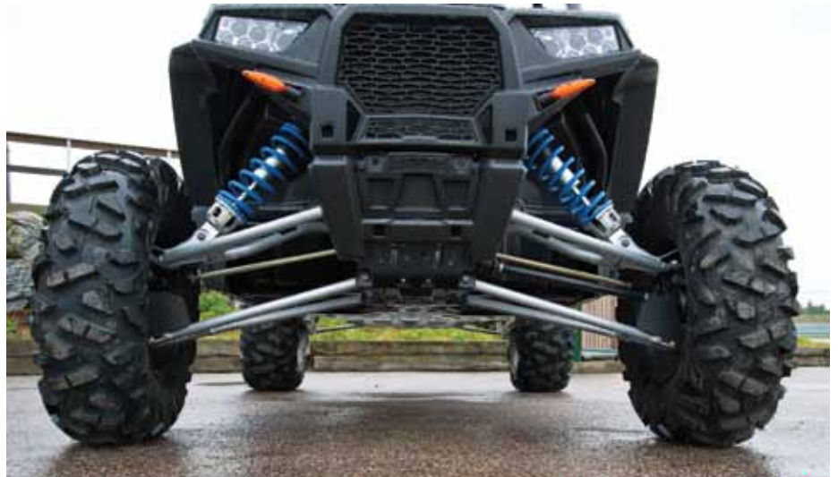
Både markfrigången på 34,3 centimeter och fjädringsvägen är väl tilltagen och 6-lagers 29" Maxxis Bighorn-däck ger både grepp och komfort.
