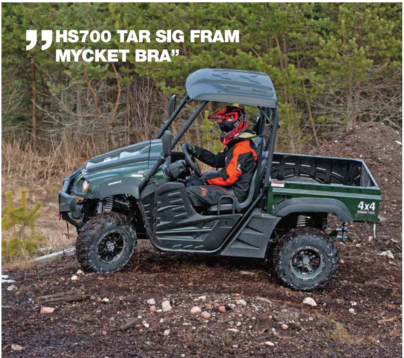
12 tums fälgar i aluminium skodda med 25x8-12 Carlisle däck fram och 25x10-12 bak.
