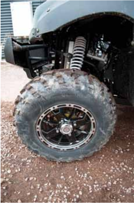
12 tums fälgar i aluminium skodda med 25x8-12 Carlisle däck fram och 25x10-12 bak.
