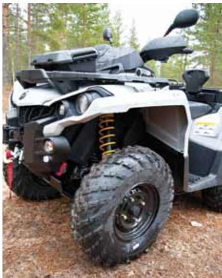
Svarta stålfälgar och grovt mönstrade 26" Carlisle Badland-däck. Notera de hårdare gula fjädrarna från Xmr 650 på testexemplaret.
