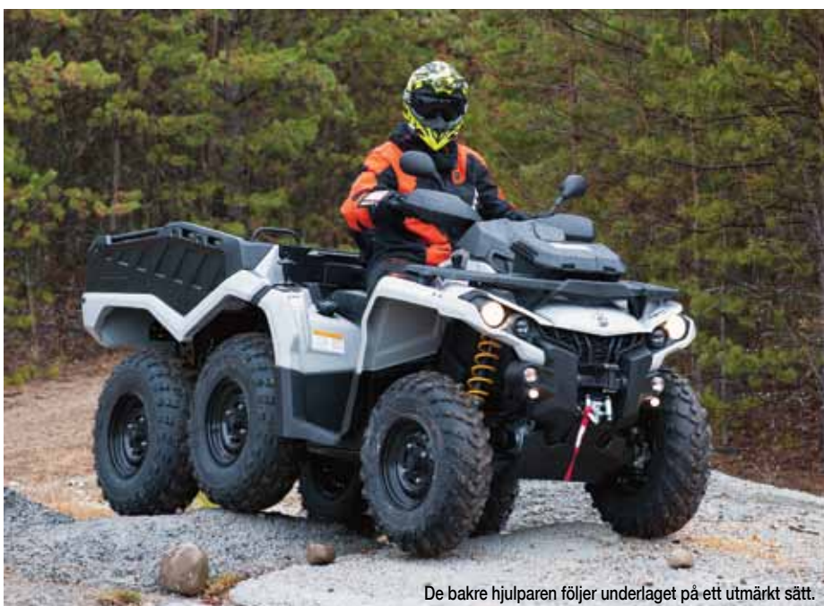
Svarta stålfälgar och grovt mönstrade 26" Carlisle Badland-däck. Notera de hårdare gula fjädrarna från Xmr 650 på testexemplaret.
