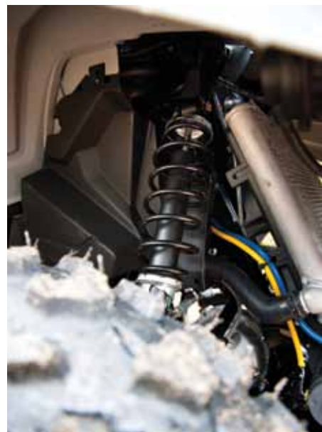
Fjädringens förspänning kan justeras i fasta lägen.
