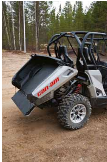
Det tvådelade flaket är tippbart och kan lasta 272 kilo.
