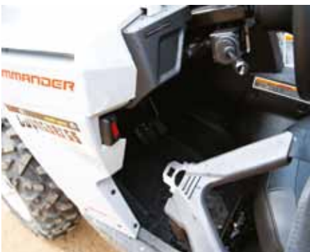
Sidonätet har ett riktigt gediget fäste likt ett säkerhetsbälte, klickar man i det när man är på utsidan är det dock lite fippligt att få upp igen.
