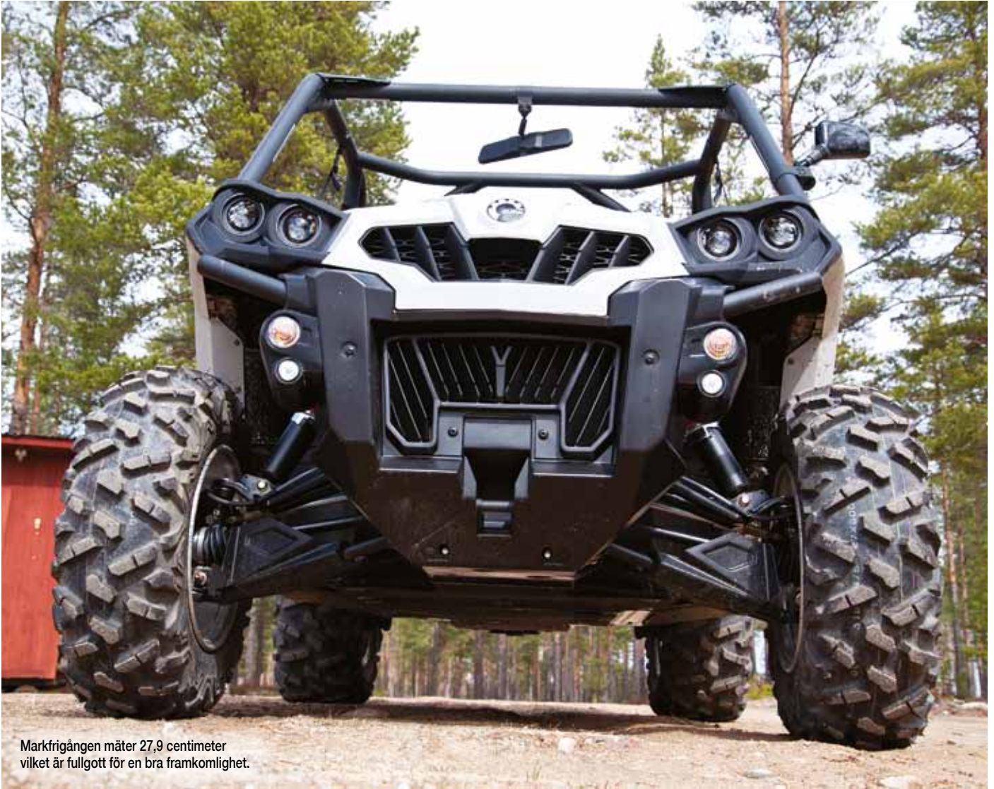
Trots lite enklare Motion Control-dämpare upplevs Commandern stabil och sportigt kalibrerad.
