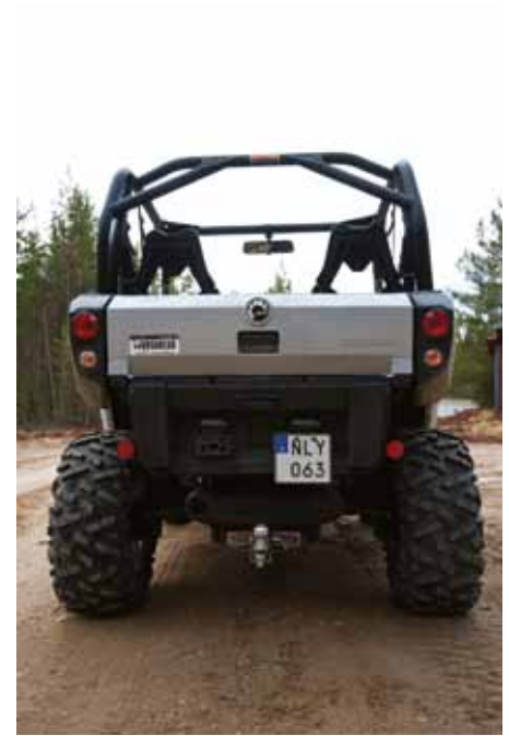
En dragkrok sitter på plats bak men vi kan sakna vinschen fram.
