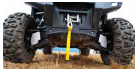
Markfrigången är helt okej på 28 cm, även om vi mätte upp 24 cm med en mjukare förspänning.
